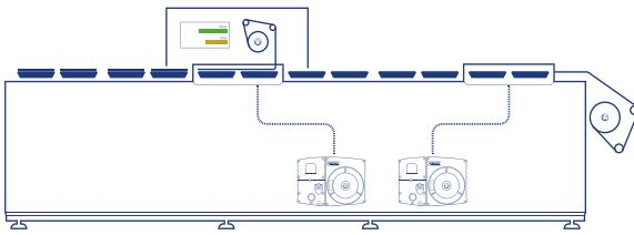
При работе в стандартных производственных условиях упаковочная машина может выполнять 10 циклов в минуту, работать 60 минут в час в двухсменном режиме. В такой конфигурации машина производит 8 упаковок за цикл.
